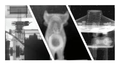
Esta es una técnica de ensayo no destructiva que utiliza los neutrones producidos en un reactor nuclear para formar imágenes del interior de objetos en los cuales se encuentren regiones con diferencias significativas en el contenido de elementos ligeros como hidrógeno, helio, oxígeno, entre otros. Esto permite; por ejemplo, identificar fallas, rajaduras o cavidades que son difícilmente detectadas.
